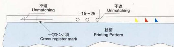
レジスターマークライン上矢印トンボ(十字トンボは良)または、その他の上記のようなマークが入っていると自動セットアップは不適です。レジスターマーク間隔は20±5(15~25mm)で自動制御します。従って15~25mmの間隔になるような他のマークはさけてください。
